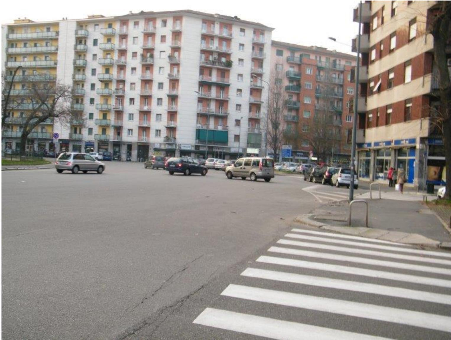
**Fotografia n.° 5: i veicoli che devono dare la precedenza si arrestano ben oltre la linea a causa dell'eccessivo spazio di manovra della rotatoria**
