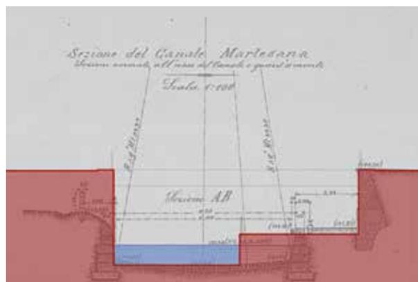
Fig. 61 schema progettuale della nuova sezione confrontata con la precedente
