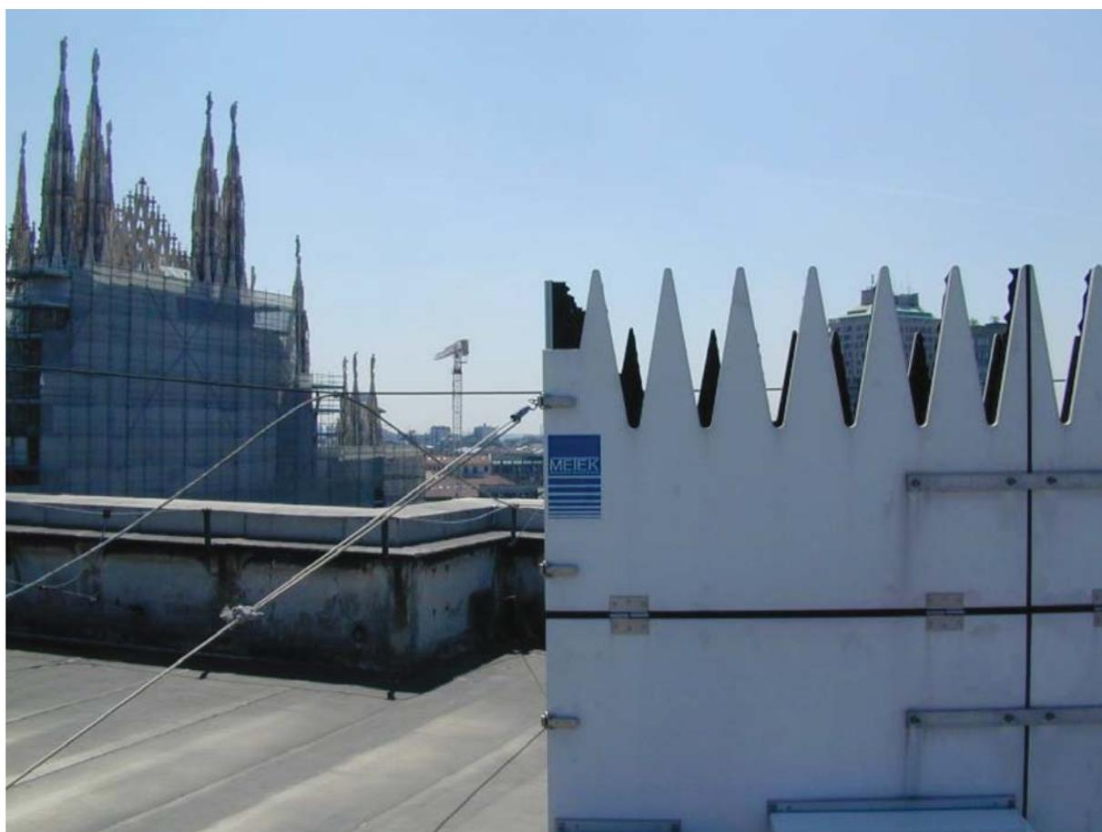
Figura 1.62 **Progetto Sentinella dell'Aria: l'anemometro ultrasonico e i sensori meteorologici installati sopra il terrazzo della galleria Vittorio Emanuele** – Fonte: Agenzia Mobilità e Ambiente
